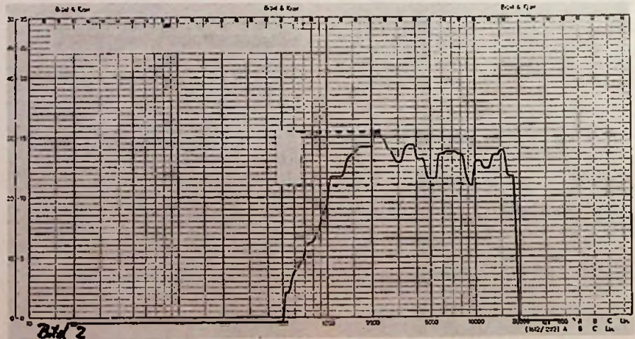
Bild 2. Übertragungskennlinie des Bändchenlautsprechers mit zugeschalteter Frequenzweiche
