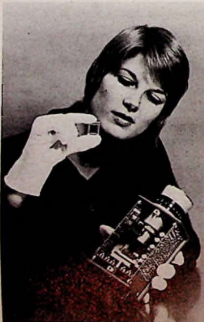
Nicht viel größer als eine semiprofessionelle Super-8-Filmkamera ist die röhrenlose Schwarz-Weiß-Fernsehkamera der RCA. Sie enthält einen nach dem CCD-(Charge-Coupled Device-) Prinzip arbeitenden Bildwandler (links oben in der Hand) mit 512 \times 320 Elementen
